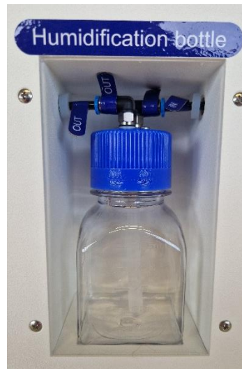
22.1 pav. Vamzdelio prijungimas prie drėkinimo butelio ir „Mini MIRI® Humidity“ daugiakamerio IVF inkubatoriaus
