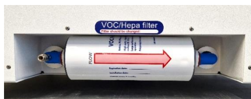
12.3 pav. Tinkamai įdėtas LOJ ir HEPA filtras
